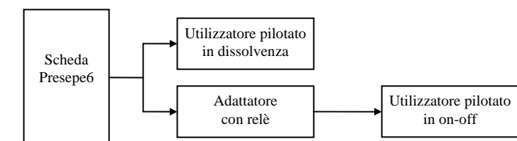
Connessioni esterne di un adattatore relè
